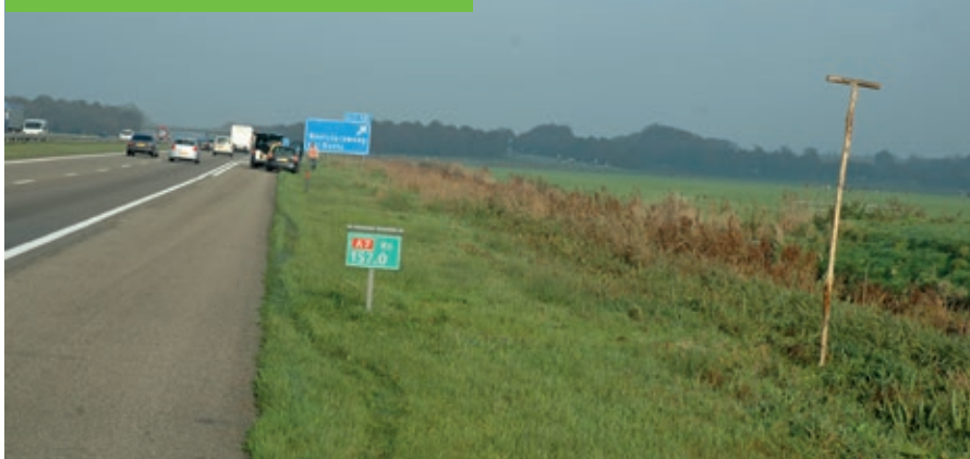
Een aangepaste hectometerpaal met de rol en de alternatieve zitplaats op 5 meter van de rijbaan.
